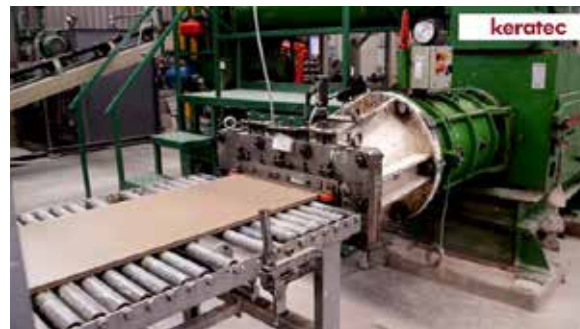
Produção de cerâmica por extrusão
